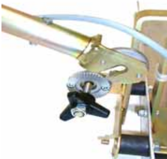
Устанавливаем и снимаем ручку управления / Adjusting and loosening of handle
